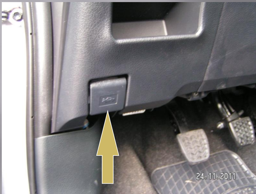
Uchwyt do zwalniania zaczepu pokrywy silnika
